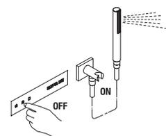
Ручная лейка душевого набора арт. 8091B+8091A автоматически включается, когда ее поднимают из держателя и выключается при нажатии на любую из регулирующих воду кнопок на панели управления арт. L101B+L101A.
