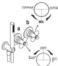
Встроенный прогрессивный смеситель для душа на 1/2" имеет 2 регулятора:
