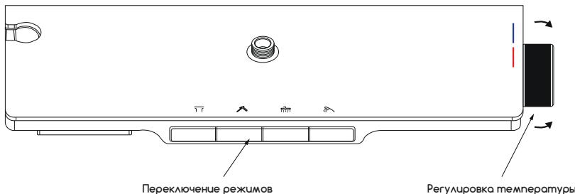
Рукоятка регулировки температуры позволяет менять температуру воды в соответствии с маркировкой на корпусе смесителя: поворотом вниз увеличивая температуру, поворотом вверх - уменьшая ее.
