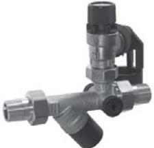
Для подключения замкнутого водонагревателя, соответствующего стандарту DIN 1988. Имеет разрешение DVGW, проверен на звукоизоляцию по классу 1. Состоит из: запорного вентиля, системы предотвращения обратного тока воды с устройством контроля, вторым запорным вентилем (DN 20), мембранным предохранительным клапаном с седлом из благородной стали Nirositz и расширяющейся сливной воронки. Корпус из прессованной латуни. Стандартные варианты 6, 8 и 10 бар.
