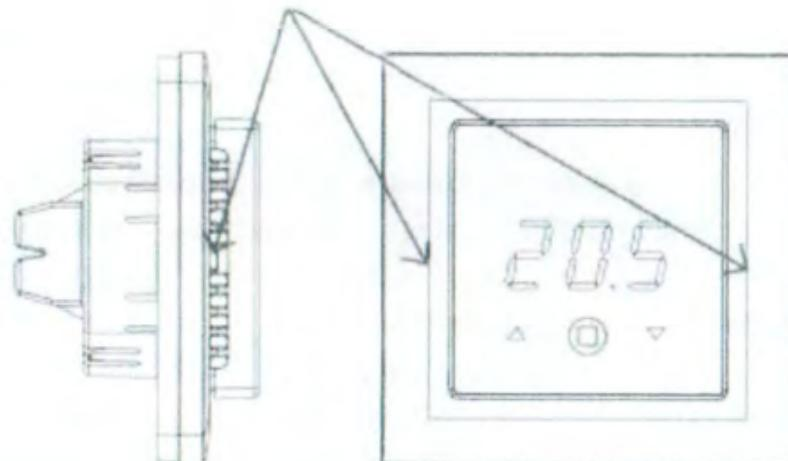
Используйте, к примеру, тонкую отвертку. Теперь переднюю крышку и раму можно снять.
