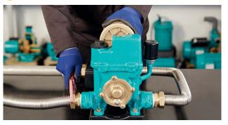
2 Снять насос с установочного места
