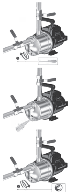
Рис. 13 Опорожнение насоса JP
