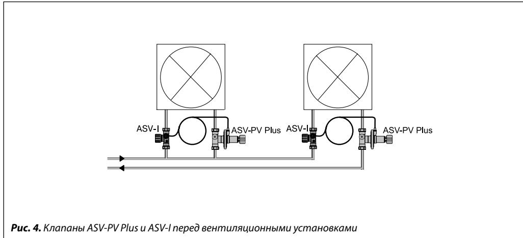
**Рис. 4.** Клапаны ASV-PV Plus и ASV-I перед вентиляционными установками
