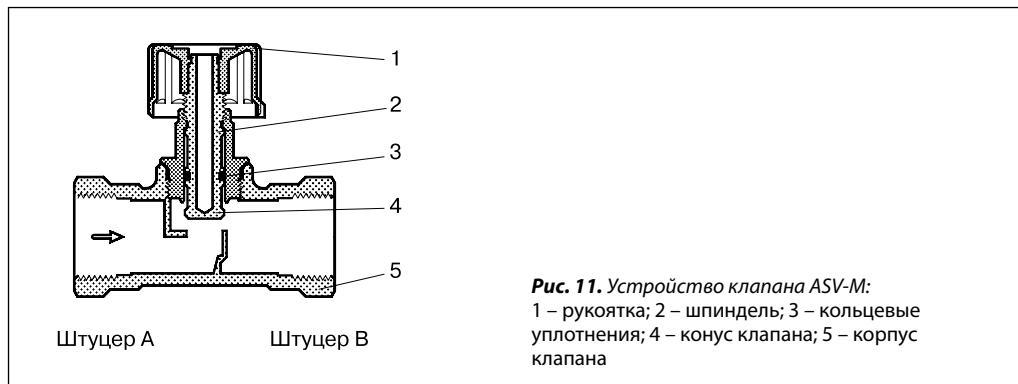
Клапан ASV-M не имеет устройства настройки и может быть использован только в качестве запорной арматуры и для присоединения им-
