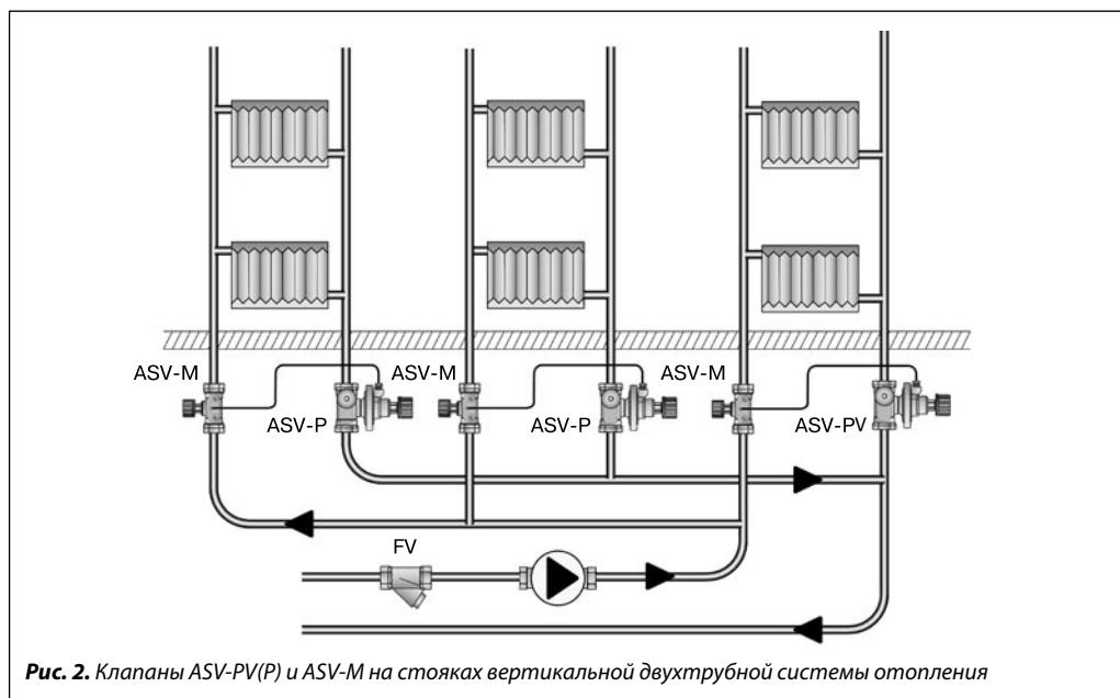
Рис. 2. Клапаны ASV-PV(P) и ASV-M на стояках вертикальной двухтрубной системы отопления
