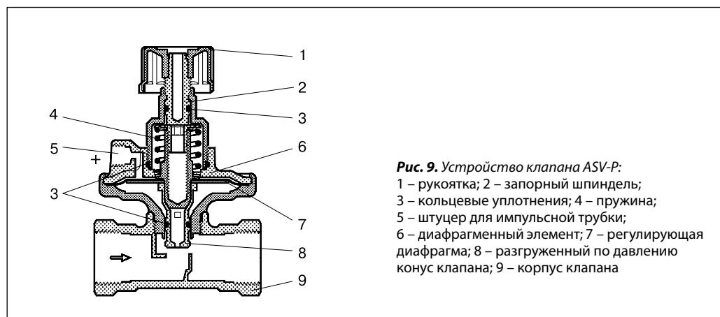
**Рис. 9. Устройство клапана ASV-P:**
