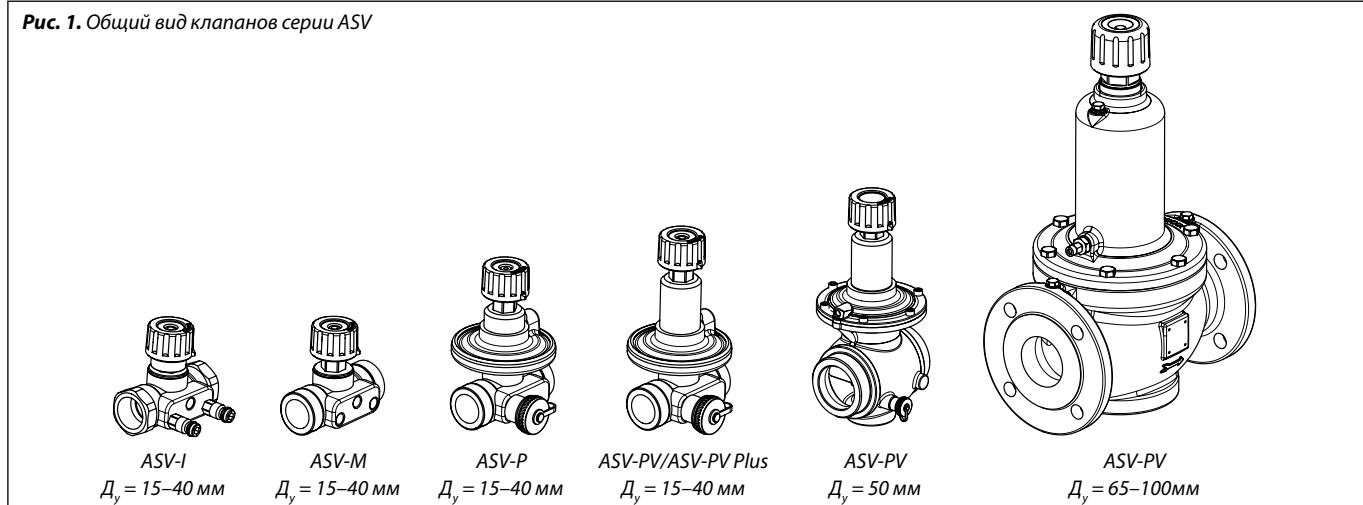
Автоматические балансировочные клапаны серии ASV — регуляторы постоянства перепада давлений, предназначенные для гидравлической балансировки трубопроводных систем тепло- и холодоснабжения при переменных расходах проходящей через них среды в диапазоне от 0 до 100%.
