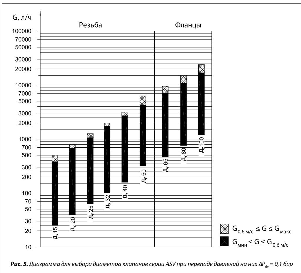
**Рис. 5.** Диаграмма для выбора диаметра клапанов серии ASV при перепаде давлений на них  $\Delta P_{\delta k} = 0,1$  бар
