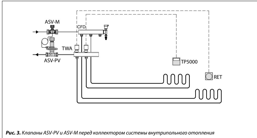
Рис. 3. Клапаны ASV-PV и ASV-M перед коллектором системы внутриводного отопления
