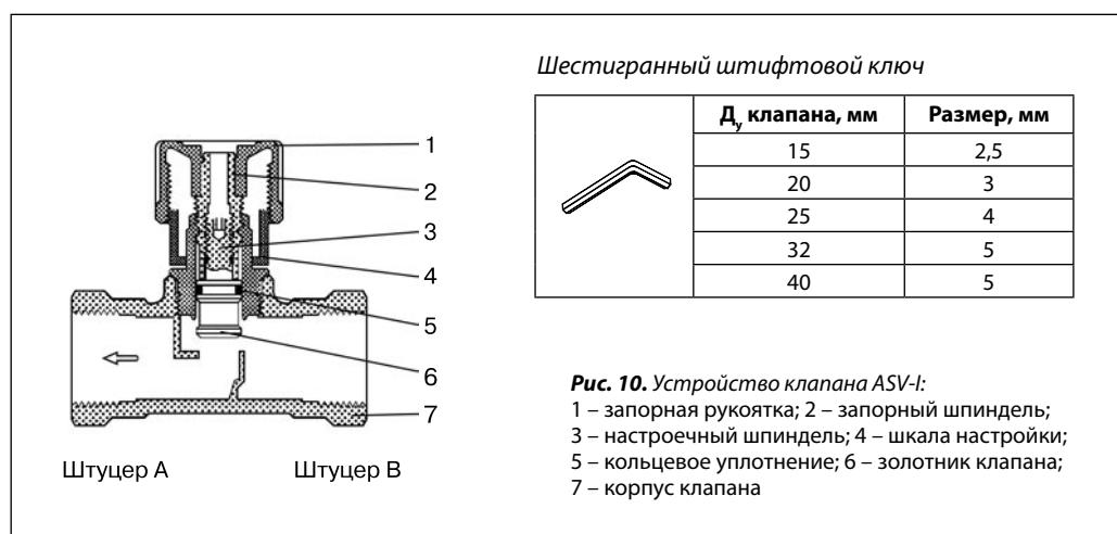
**Рис. 10. Устройство клапана ASV-I:**
