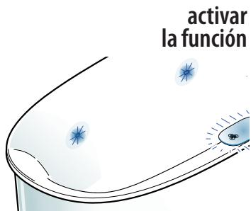
■ Para activar la función, presionar durante unos 4 segundos la tecla ≈: los jets y la pantalla parpadean y se activa la bomba (durante aproximadamente un minuto) para hacer circular el líquido por dentro del circuito hidráulico.
