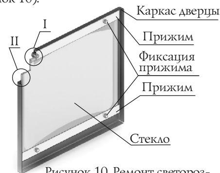
Рисунок 10. Ремонт светопрозрачного экрана дверцы.
