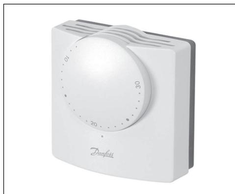
Комнатный термостат RMT предназначен для управления системами отопления, вентиляции и кондиционирования воздуха. При отклонении температуры воздуха в помещении от заданной, термостат замыкает и размыкает электрические цепи регулирующего устройства (например, привода клапана терморегулятора на радиаторе системы отопления).
