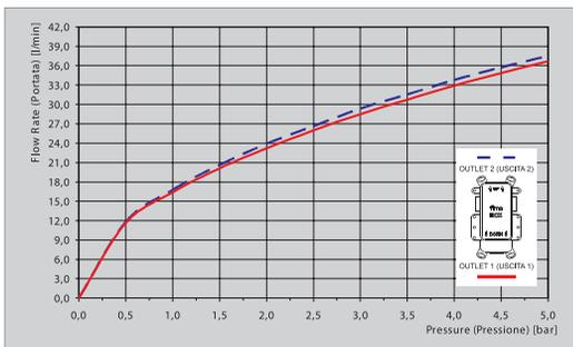
PROGRESSIVE CARTRIDGE Ø35 | КАРТРИДЖ ПРОГРЕССИВНЫЙ Ø35
