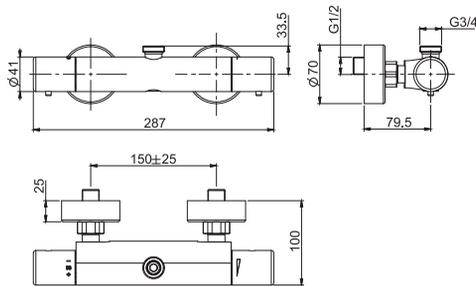
**Термостатический смеситель внешнего монтажа без душевого комплекта С МЕТАЛЛИЧЕСКИМИ РУЧКАМИ с верхним выводом**
