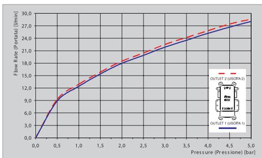
THERMOSTATIC CARTRIDGE Ø42 | КАРТРИДЖ ТЕРМОСТАТИЧЕСКИЙ Ø42
