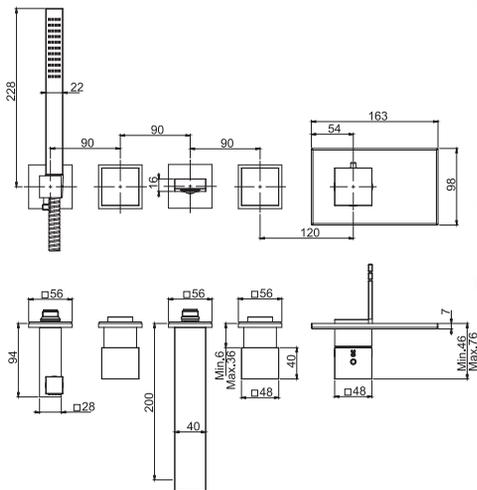
**Встроенный термостатический Смеситель для ванны на два потребителя**
