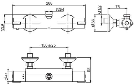
**Термостатический смеситель внешнего монтажа без душевого комплекта с верхним выводом**
