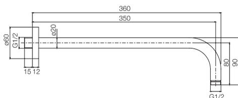
**Держатель для монтажа на стену 350 мм-1/2**
