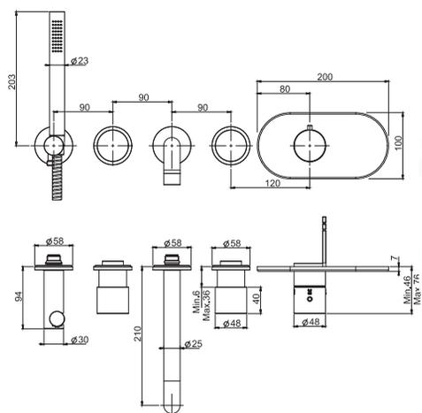
**Встроенный термостатический Смеситель для ванны на два потребителя**
