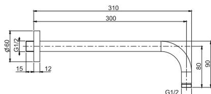
**Держатель для монтажа на стену 300 мм-1/2**
